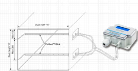
Рис. 2. Монтаж FloXact™-L
