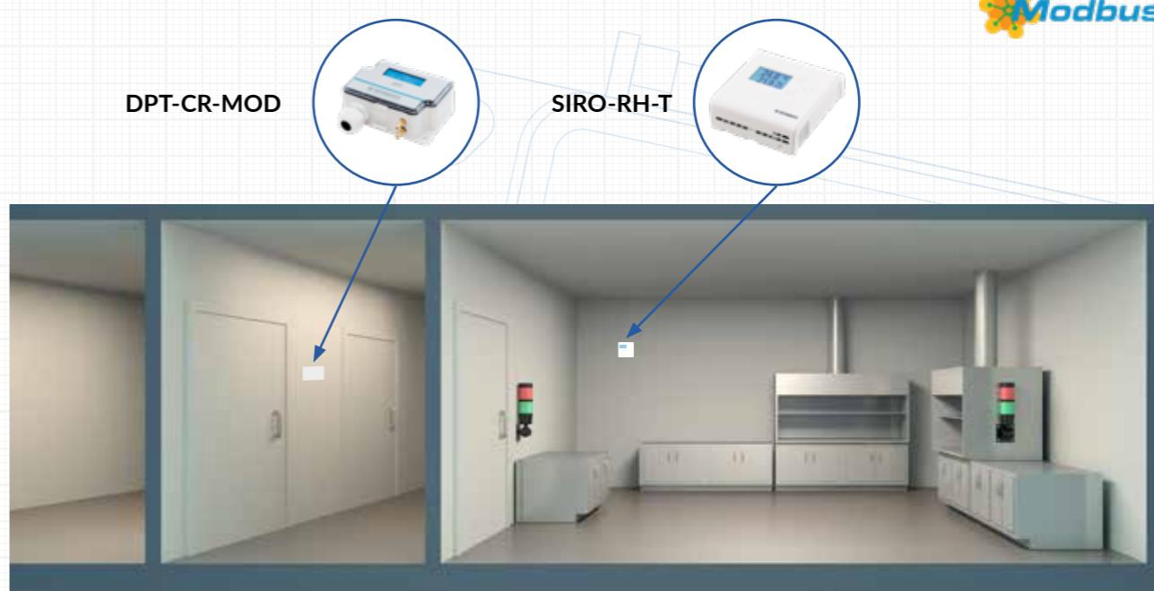
DPT-CR-MOD измеряет перепад давления между стерильным помещением и соседним с ним помещением и передает информацию системе автоматизации по протоколу Modbus для поддержания оптимальных условий в стерильном помещении. DPT-CR-MOD подключен к датчику качества воздуха в помещении Siro, который измеряет относительную влажность и температуру. Siro передает информацию датчику DPT-CR-MOD, который отображает ее на своем дисплее вместе с параметром перепада давления.
