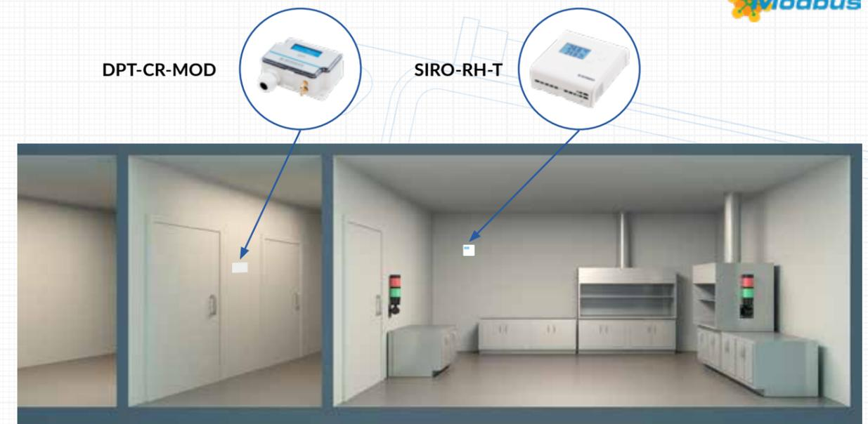
Le DPT-CR-MOD mesure la différence de pression entre la salle blanche et l'antichambre et envoie les informations au système d'automatisation via le protocole Modbus afin de maintenir des conditions optimales dans la salle blanche. Le DPT-CR-MOD est connecté au transmetteur de la qualité de l'air Siro, qui mesure l'humidité relative et la température. Siro envoie les informations au DPT-CR-MOD qui les affiche sur son écran, ainsi que les mesures de pression différentielle.
