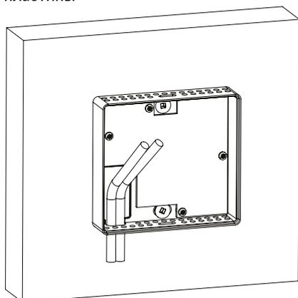
Провода могут быть протянуты через нижнее выбивное отверстие
