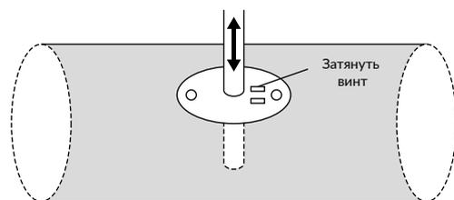
Рисунок 1с - Направление монтажа
