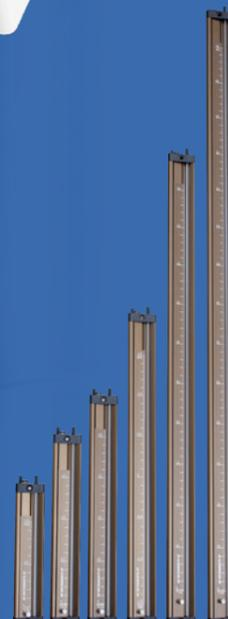
I manometri a colonna di liquido sono misuratori di pressione tradizionali affidabili e economici. I manometri sono adatti per la misurazione e l'indicazione di lievi sovrappressioni, vuoti e pressioni differenziali di aria e gas non aggressivi in intervalli di bassa pressione.
