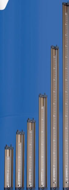
Les manomètres à colonne de liquide sont des appareils de mesure de pression fiables et peu coûteux. Les manomètres permettent de mesurer et d'afficher de faibles surpressions, des dépressions et des pressions différentielles de l'air et de gaz non-agressifs dans des plages de pressions faibles.
