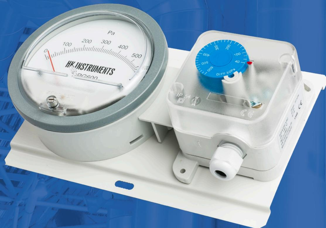
Les alertes de filtre sont la solution pour les systèmes exigeant simultanément une indication visuelle de la pression sur site et un point de commutation. Elles sont idéales pour les travaux de climatisation et de ventilation, et plus particulièrement pour les tâches de contrôle de la contamination des filtres à air.
