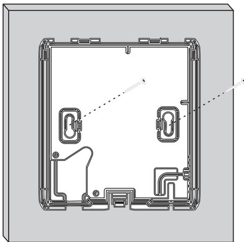
Рисунок 1б - Поверхностный монтаж
